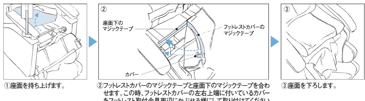
●フットレストの取り付けを行う前にPOWER(主電源)スイッチが「OFF」になっていることを確認してください。
