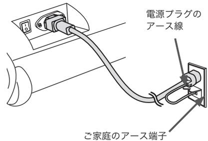
電源コードは、必ず本機器に付属のものをご使用ください。とくに、電源コードのプラグ部にアース線がついていないものは万一の感電を防ぐことができませんので使用しないでください。
