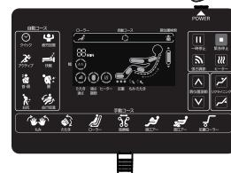
⑤リモコン上部の電源スイッチをリモコンが点灯するまで長押しします。
