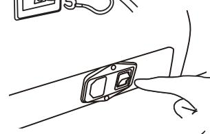
③電源コードのプラグを正しく電源コンセントに差し込みます。
