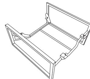
チェアスタンドのネジ穴とマッサージチェア本体の底面にある取り付け用穴をあわせ、付属の六角レンチを使用して、ネジで4箇所固定してください。取り付けの際、チェアスタンドのネジ穴とピンを間違えないように注意してください。固定後、全てのネジにゆるみがないか確認してください。確認後、リモコンをスタンドの枠をくぐらせます。このとき、リモコンケーブルが絡まないように注意してください。
