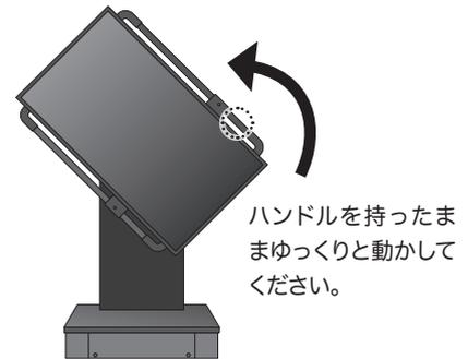
3 モニターが横向き状態になると、回転は停止します。モニターの回転範囲は90°です。回転方向は決まっていますので、回転方向以外に無理な力を加えないでください。
