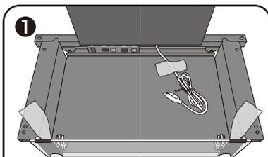
1 スタンド設置時は、ラックボックスのガラス蓋や電源コードを仮止めしています。仮止めテープを3箇所外してください。
