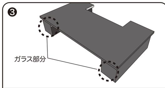
3 取り外し後、ラックボックスの天面を上にして置いてください。ガラス部分を下にして置くと、ガラス部分が傷つく恐れがありますので、ご注意ください。
