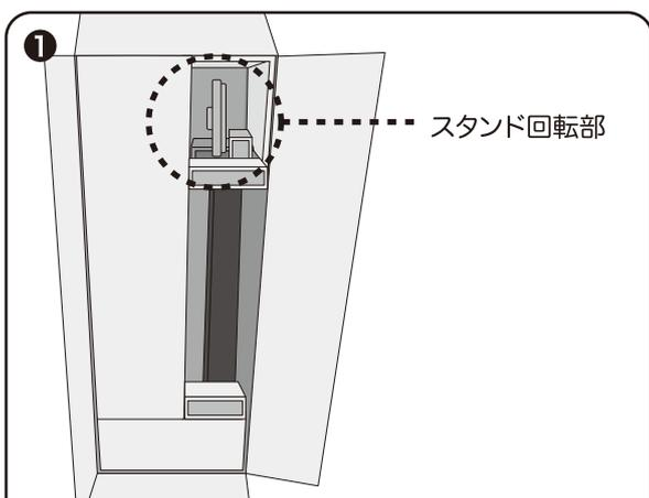
スタンドの回転部が上にくるように回転台箱を立てます。回転台箱を立てる前に、スタンドの向きを確認してから、おこなってください。その後、ラックボックス、スタンドの上下を保護している緩衝材をそれぞれ取り外します。
