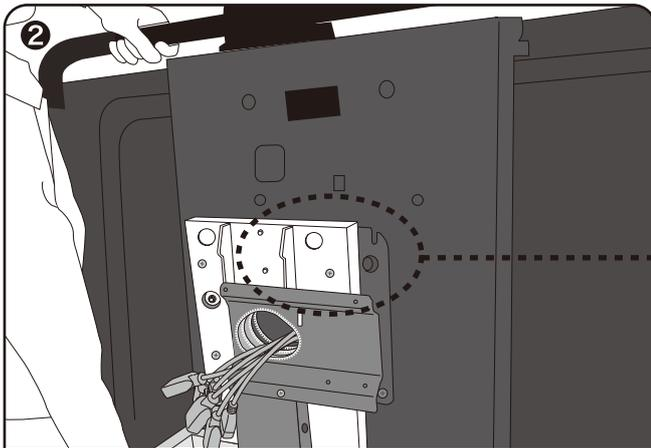
モニター背面にモニター取り付けねじが2か所仮止めされていますので、スタンドのU字型のくぼみに引っ掛けてください。
