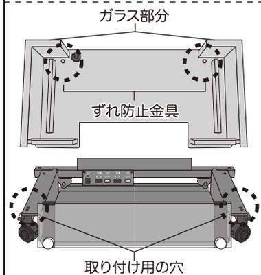
3 スタンドのガラス扉を倒して開け、スタンド下部を上から覆うように、ラックボックスを被せます。ラックボックス裏側には、ずれ防止金具がついています。スタンド下部の取り付け用の穴にはまるように、ラックボックスを被せてください。取り付け後、スタンドのガラス扉を閉めてください。
